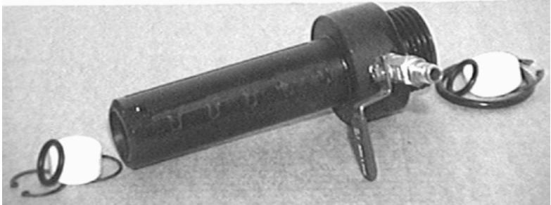
После чистки все детали тщательно осматриваются и при необходимости производится замена. Перед сборкой все уплотнения и подшипники следует смазать герметиком TONISCO sealant. Мы не рекомендуем использование других герметиков, так как большинство из них негативно влияют на важные характеристики эластичности уплотнительных колец.
